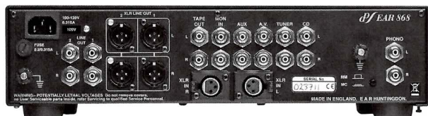
出力はアンバランス、バランスともに各2系統用意。フォノ入力 of MM/MC ゲイン切替は、端子左側のプッシュボタンで行なう。
