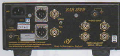
出力端子にXLRとRCAをそれぞれ1系統備えており、スイッチにて出力システムを選択できる
