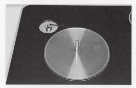
DC モーターによりアルミ製インナーブラッターをベルトドライブする二重構造を採用。センタースピンドルの軸受けは、強化スチールシャフトとテフロンミラーコーティングが施されたブロンズブッシュ・スリーブの組合せ
